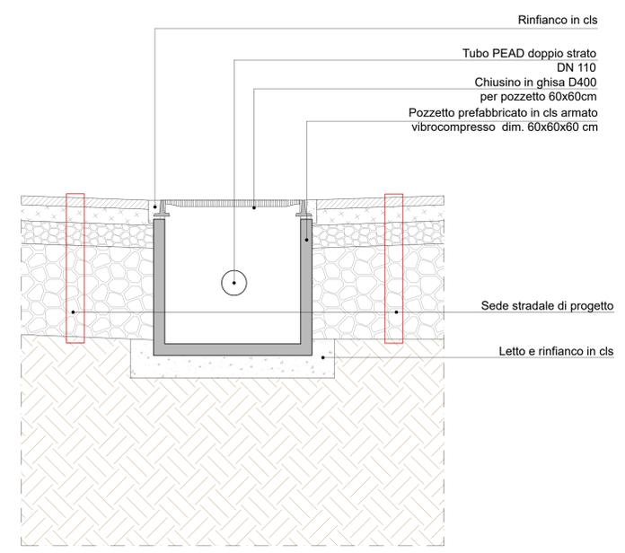
Dettaglio costruttivo pozzetto d'ispezione rete elettrica scala 1:10
